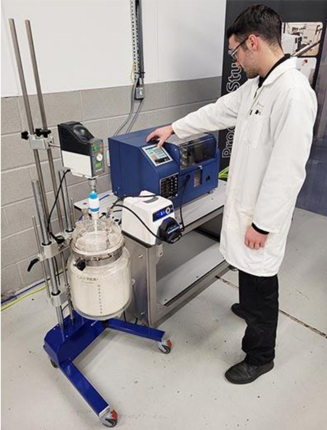
**Bildunterschrift:** AMT-Reinraumbetrieb mit einem Coflore® Durchflussreaktor, der von einem effizient gerührten Behälter in einem ReactoMate ATOM-Ständer gespeist wird.
